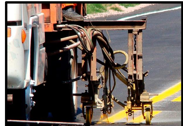
O MSV 2/110 segue com um Programador de cadênci a que permite programar demarcações (pinturas) viárias de alta precisão para até 3 pistolas de modo manual e automático com programação individual para cada uma delas.
